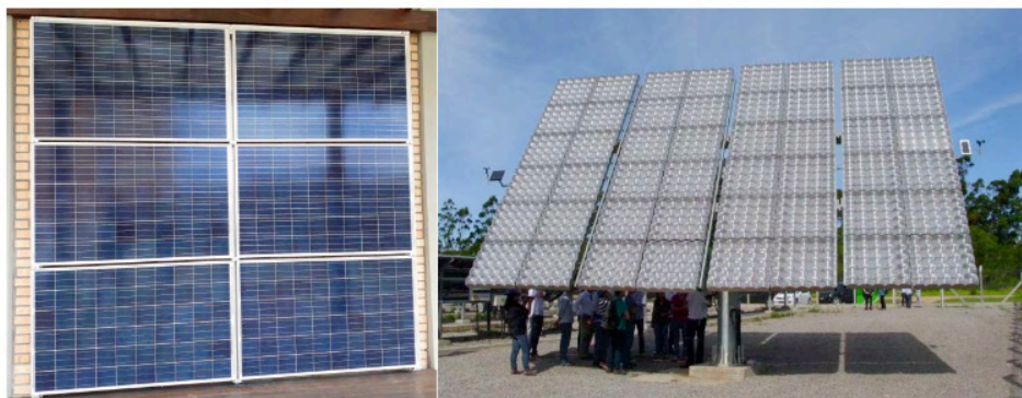
Figura 18: Módulo fotovoltaico convencional (esq.) e módulo fotovoltaico concentrador (dir. [19] ).
