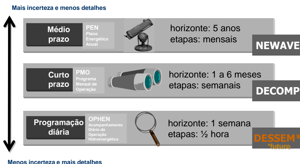
Figura 6 Etapas de estudos e cadeia dos principais modelos matemáticos utilizados no planejamento e programação da operação energética
