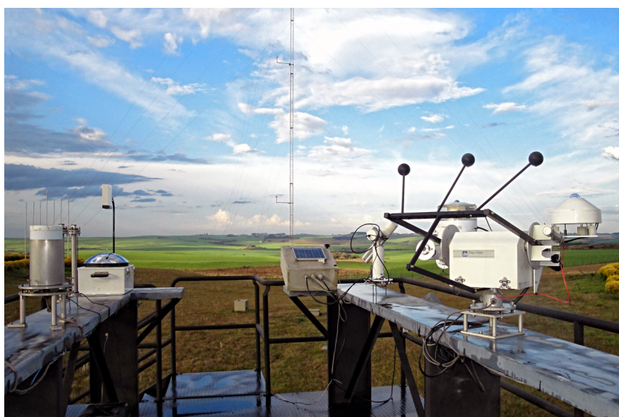
Figura 26. Foto de uma estações de coleta de dados de radiação solar da rede SONDA, localizada em São Martinho da Serra, RS, empregada na validação do Atlas.
