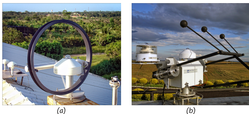
Figura 24. Sistemas para sombreamento do piranômetro utilizados na aquisição de dados de radiação difusa: anel de sombreamento (a) e esfera de sombreamento com rastreador solar (b).
