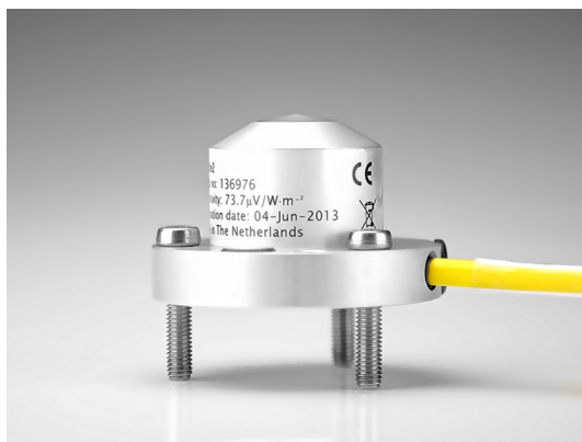
Figura 22. Piranômetro de fotodiodo de silício. Fonte: Kipp&Zonen (2016).
